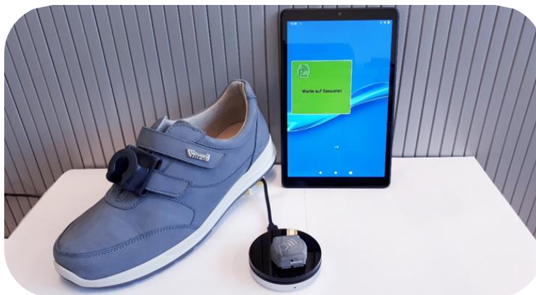
Gesamtset: Beispielschuh mit Sensorclip, Sensor auf induktiver Ladeplatte, Tablet mit Applikation.
